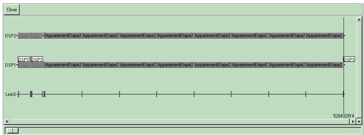
Figure 39 : Distribution/ordonnancement de l'algorithme en bi-processeur avec parallélisme de données.
