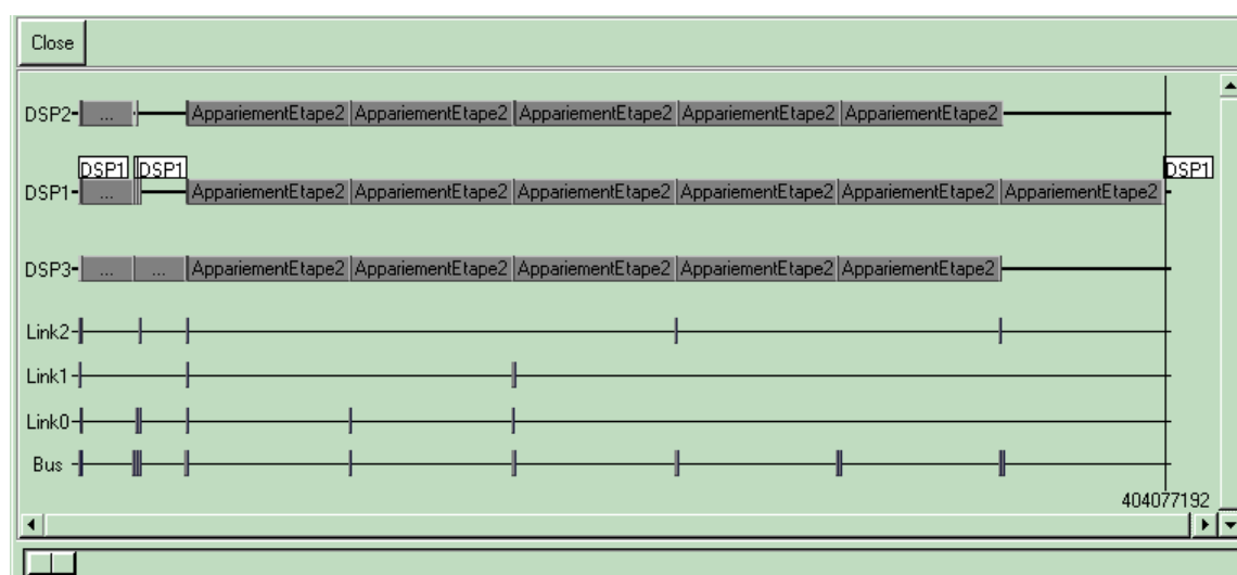
Figure 43 : Distribution/ordonnancement de l'algorithme sur l'architecture à 3 processeurs, avec topologie point à point en anneau +bus.
